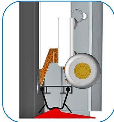
Profil de seuil en caoutchouc à coller au sol entre les rails.
